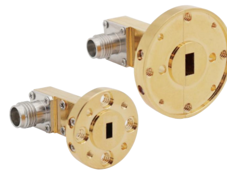
1.85:WR15 -1.85K 33~65GHz 最大驻波比 \leq 1.40
