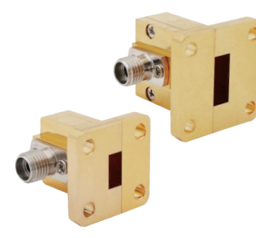
2.92:WR28 -2.92K 18~40GHz 最大驻波比 \leq 1.25
